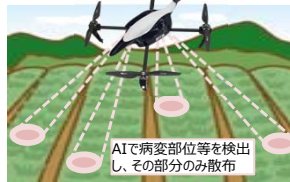
農薬散布（ピンポイント散布） AIで病変部位等を検出し、その部分のみ散布
