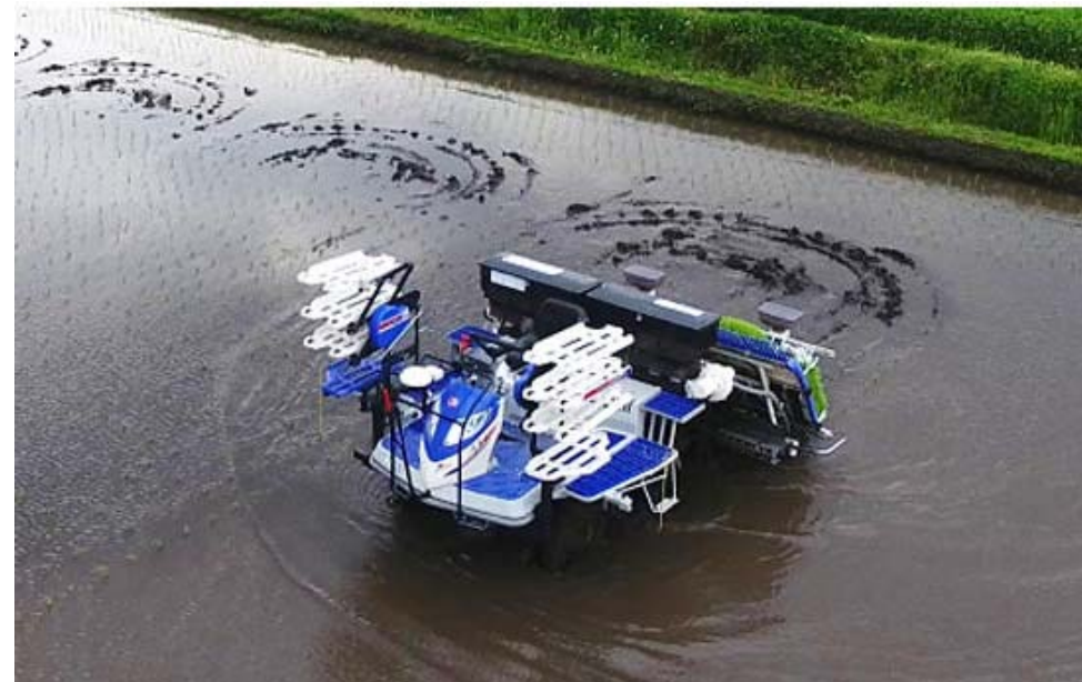
無人作業中の自動運転田植機（自動旋回の様子）
