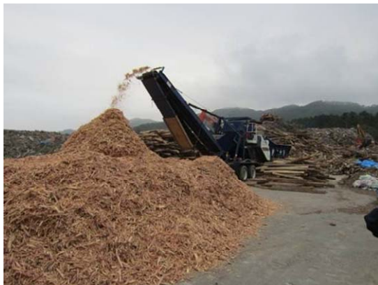
図9 瓦礫廃木材の再利用(チップ化(左)と復興ボード活用の集会所(右))
