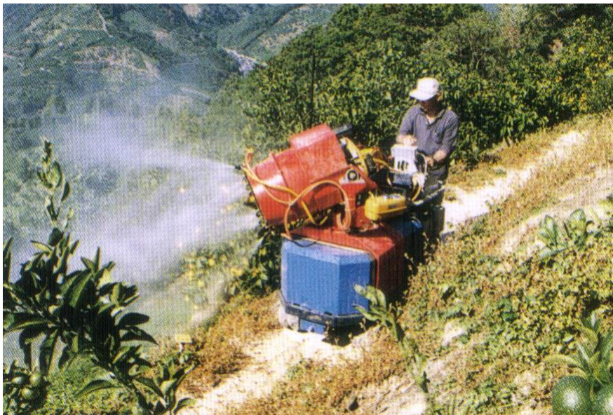
写真 2 小型風筒式防除機
