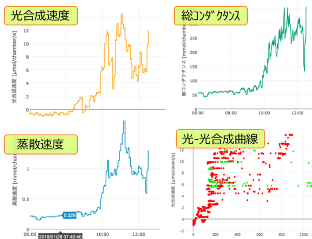
図 3 光合成・蒸散・コンダクタンスのモニタリングが可能なウェブアプリの概略 (右下: 計測データを用いた光-光合成曲線)
