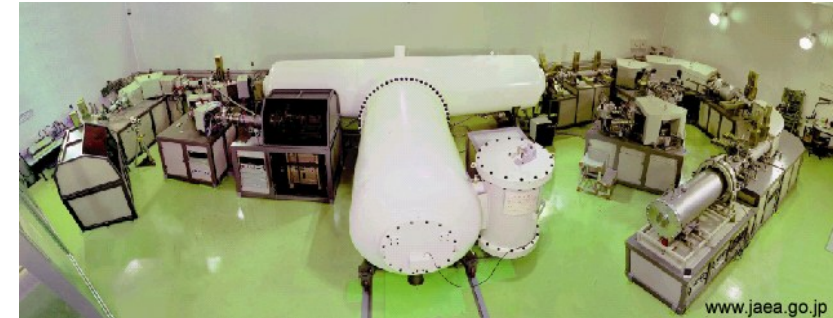
加速器質量分析技術で、炭素原子約1兆個に1個の希少な放射性炭素を正確に測定
